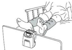
2) Conecte el conjunto de tubos a la bomba. Asegúrese de que los conectores de tubos quedan bien sujetos en los conectores de la bomba.
